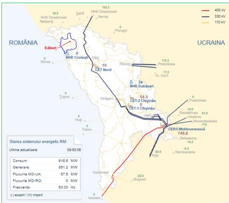
Figura 17: Încadrarea mun. Edineț în sistemul energetic național
