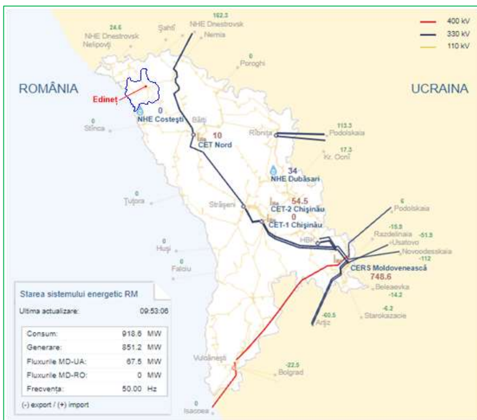
Figura 17: Încadrarea mun. Edineț în sistemul energetic național
