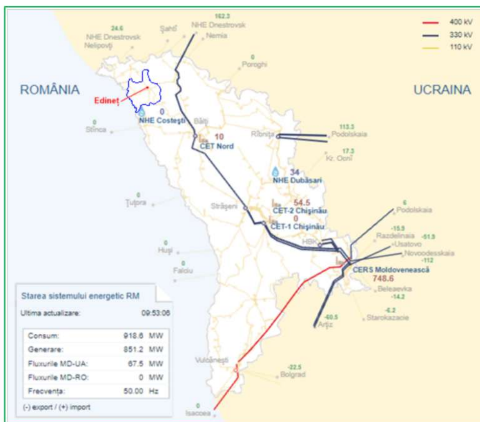
Figura 17: Încadrarea mun. Edineț în sistemul energetic național
